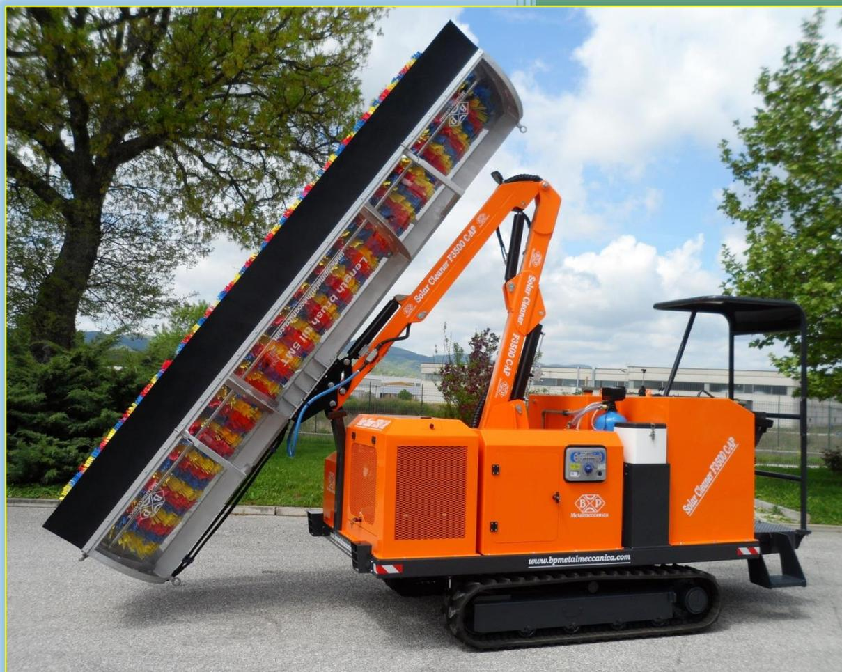
Solar Cleaner F3500 C-AP è la versione semovente della serie di macchine per la pulizia di pannelli fotovoltaici prodotta da B.P. Metalmeccanica.
